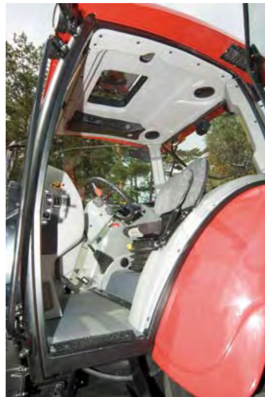
Современная кабина с четырьмя стойками
