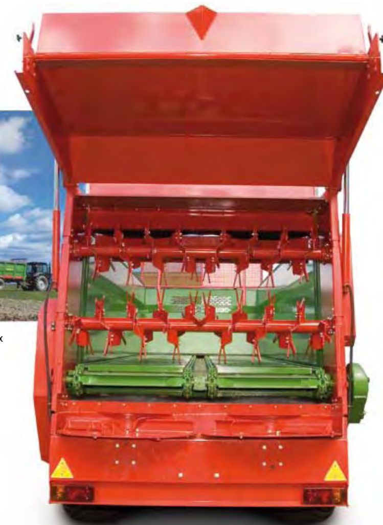
Узел червячных барабанов тщательно размельчивает навоз
