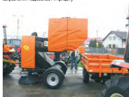
Уборочная машина с увеличенным вместилищем загрязнения подъезжает к прицепу
