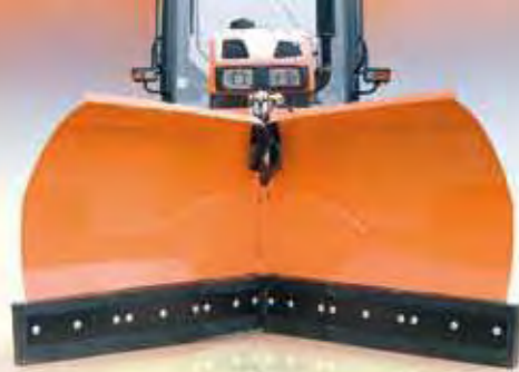
Рабочая позиция отвалов PU-1700 и PU-2100 Захват вперед
