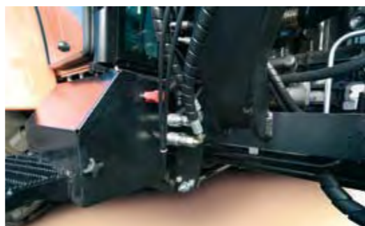
Пара соединительных гидравлических стыков с тыла
