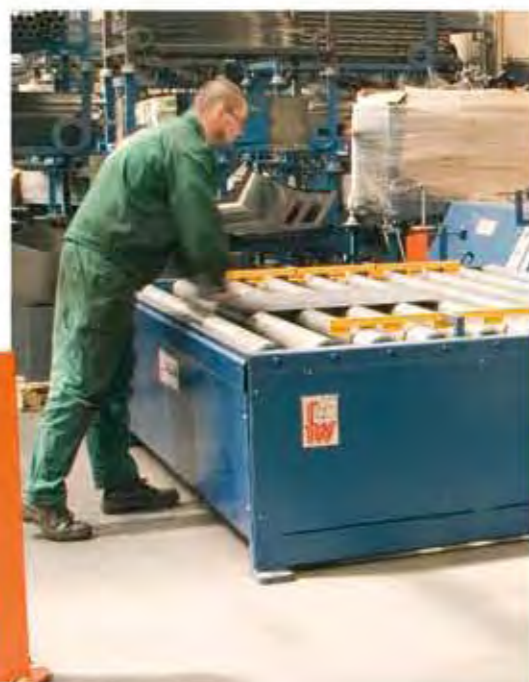
Работник размещает лист жести на подающем столе
