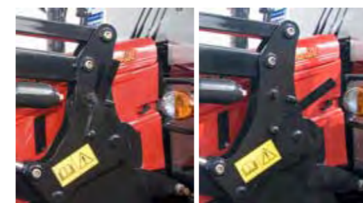
Система быстрого и уверенного крепления погрузчика
