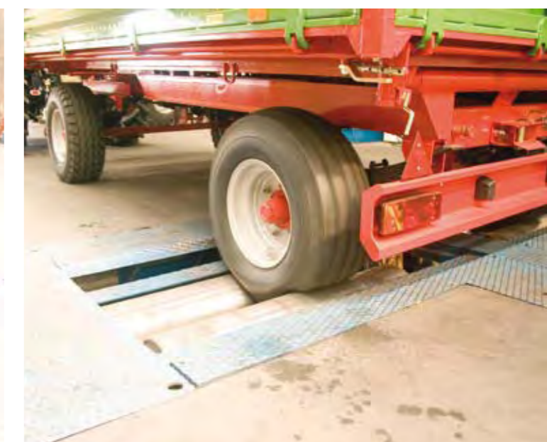
Измерение силы торможения и проверка разницы сил торможения колёс оси с нагрузкой
