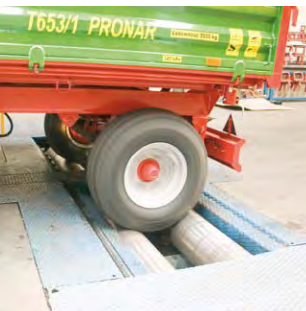
Измерение силы торможения оси не загруженного и проверка разницы сил торможения правого и левого колеса, которая не должна превышать 20%
