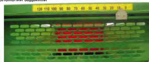
Расположенный на переднем борту показатель сообщает о точном местоположении задвижки
