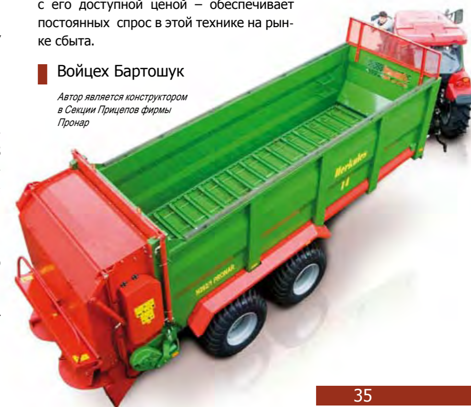
Загрузочной монолитный бункер представляет собой жесткую и прочную конструкцию
