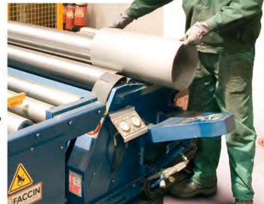
Затем элемент о данной форме снимается из вальсов
