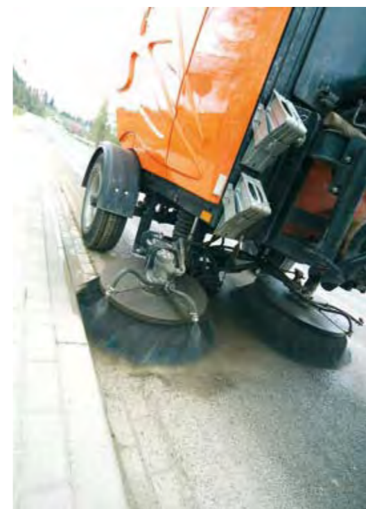
Расительная система и щетка подметательно – уборочной машины ZMC 2.0
