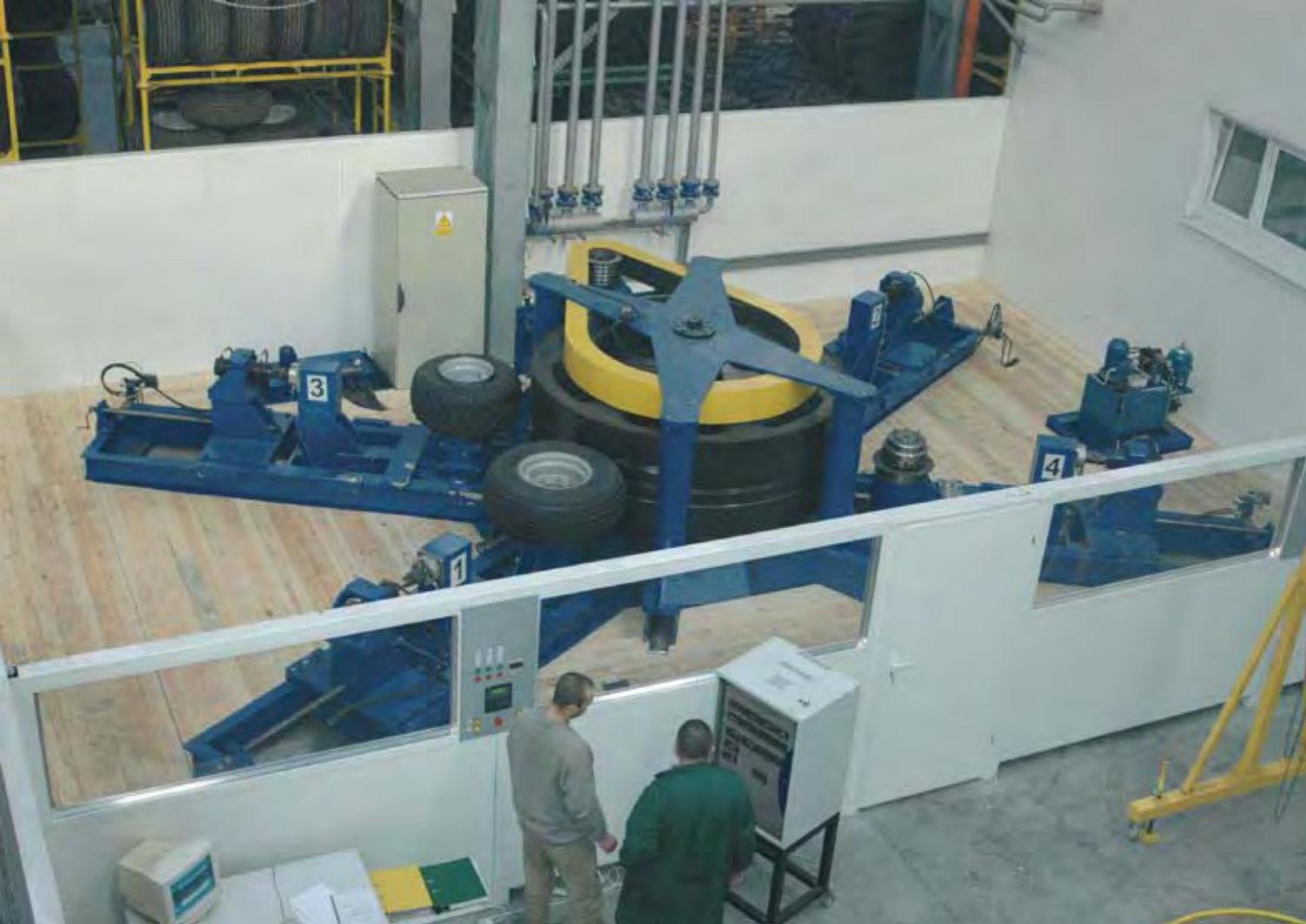
Исследовательская лаборатория - испытание колеса на радиальную нагрузку
