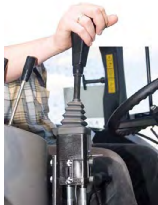
Управление одним эргономично расположенным рычагом
