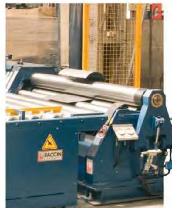
В автоматическом цикле наступают очередные фазы гнутья
