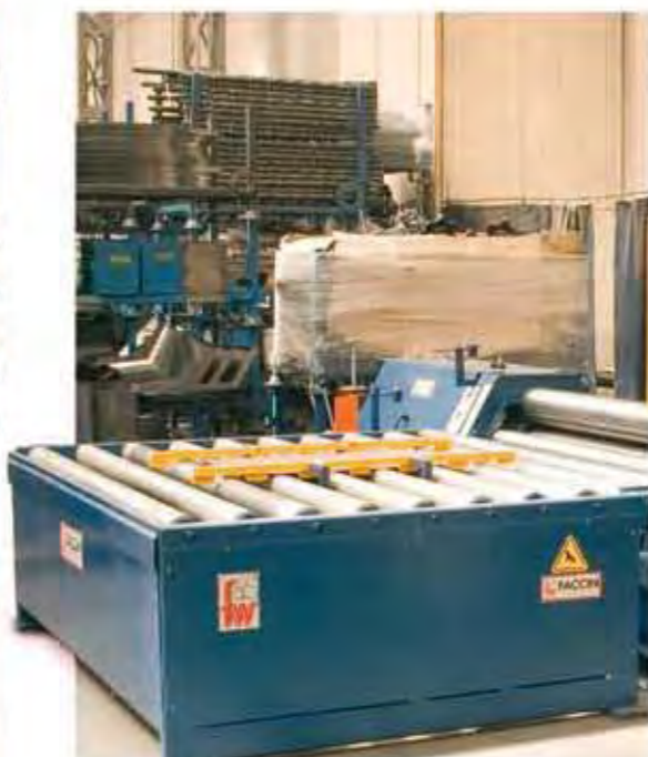
Стол оснащен системой центрирования листа жести. При помощи роликов материал перемещается в сторону вальсов
