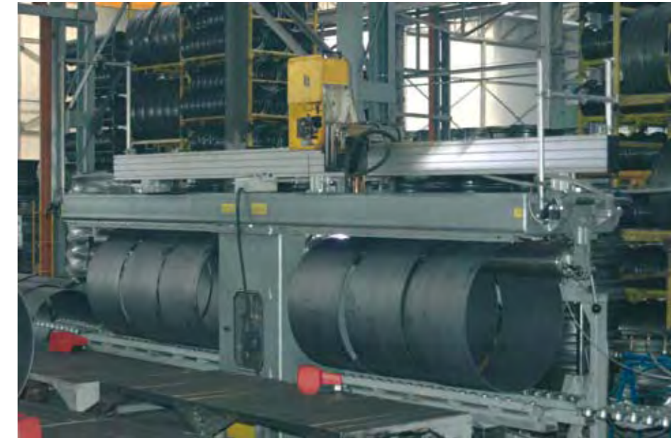
Установка для плазменной сварки колец – толщиной 16 мм.
