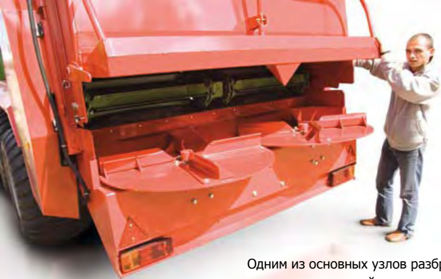
Благодаря диску с регулировкой лопастей можно устоявить оптимальную ширину разброса
