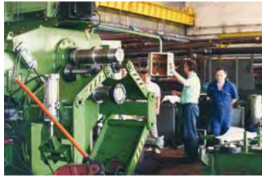
Запуск первой производственной линии профилирования ободов. Благодаря постоянному совершенствованию и установке все более современной технике Пронар производит колёса для тихоходных машин, тракторов, строительных, лесных и дорожных, а также военных машин
