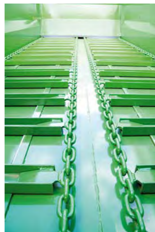
Скреплённые цепи и пластины толщиной 14 мм гарантируют безотказность в работе
