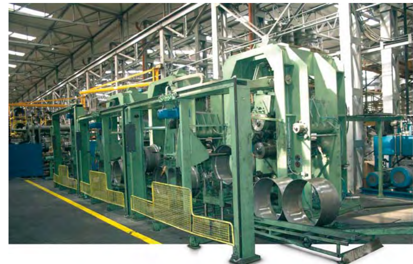
Новая линия для профилирования дисков
