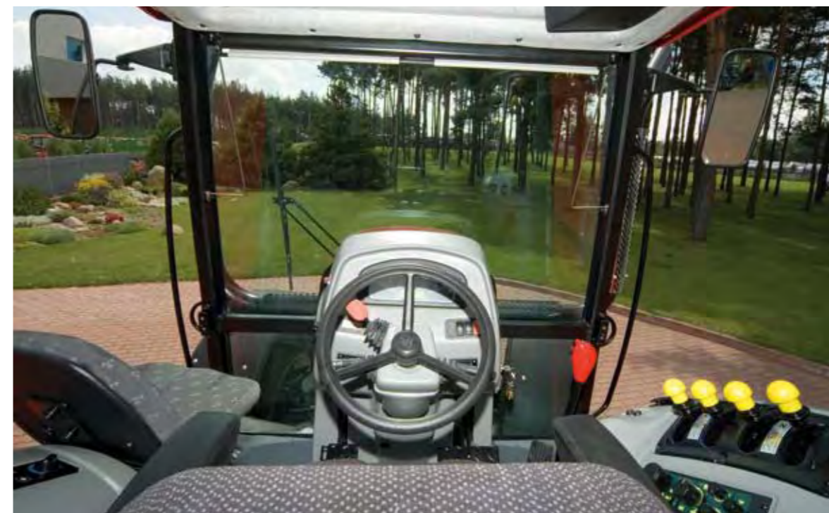
Отсутствие боковых и средних стоек обеспечивает превосходную видимость
