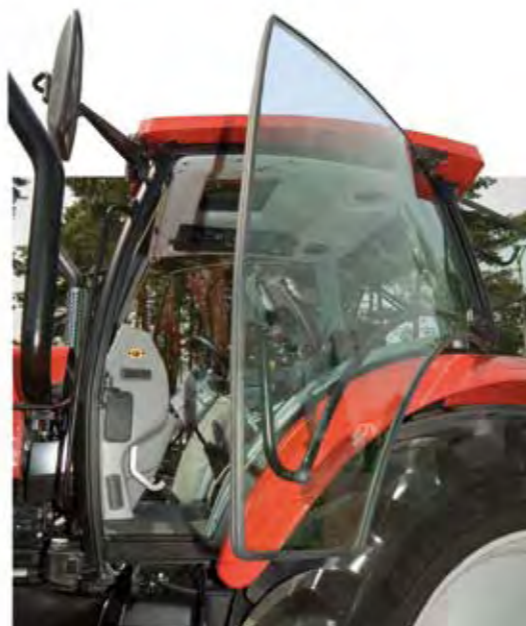
Выгодный, широкий вход- это следующее достоинство кабины с четырьмя стоиками
