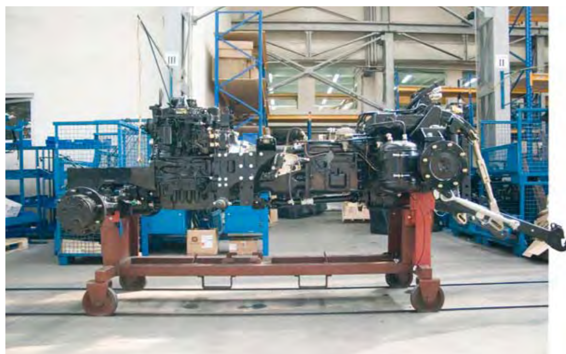
Трансмиссия ZF в тракторе серии P5
