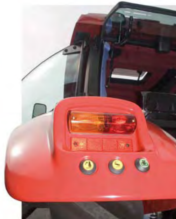
Включимые снаружи кнопки помогают подключить машину без необходимости посадки и высадки с трактора
