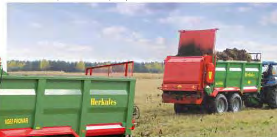
Адаптер точно и равномерно разбрасывает различного рода органические удобрения на расстоянии от 12 до 25 м
