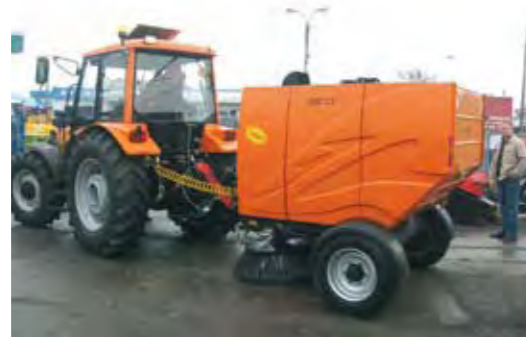
Уборочная машина с увеличенным вместилищем загрязнения подъезжает к прицепу
